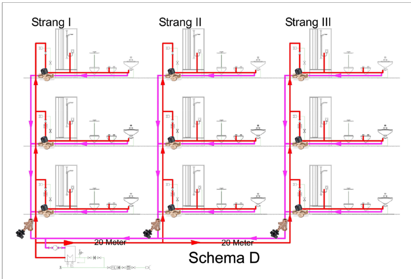
Schema D: Zu den Entnahmestellen wird mittels thermostatischen Ventils reguliert, an den Strängen drosselt ein Ventil mit Festwert
